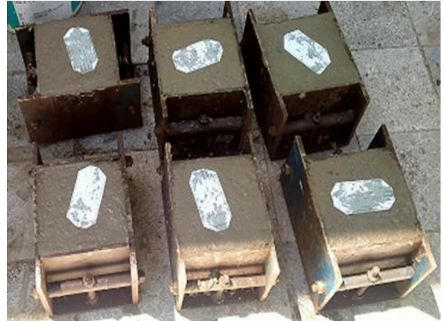
Hình 4. Mẫu bê tông xi măng
