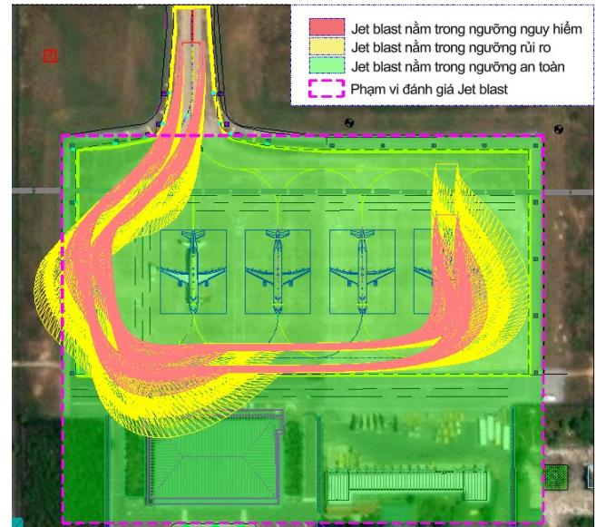
Hình 15. Khoanh vùng an toàn khi máy bay khởi hành từ vị trí đỗ 04
