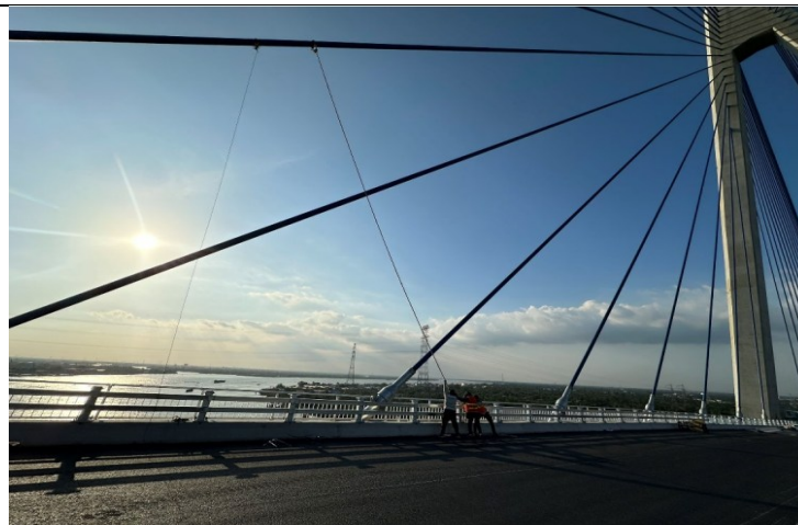
Hình 7. Hình ảnh thí nghiệm hiện trường đo độ giảm chấn dây văng [14]
