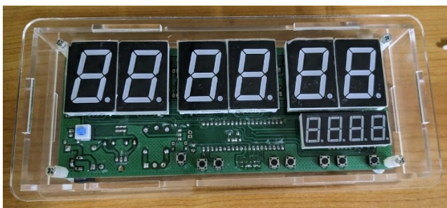
Hình 24. Lắp ráp mạch đồng hồ với tấm mica
