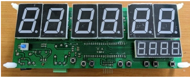
Hình 22. Mạch đồng hồ thời gian thực
