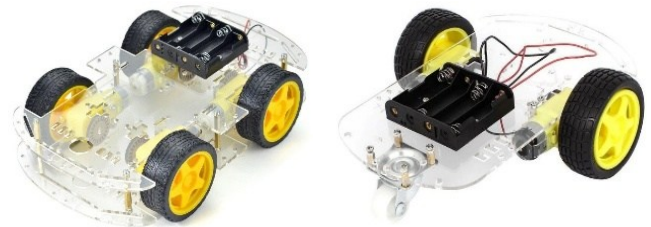
Hình 3. Khung xe 4 bánh và khung xe 3 bánh
