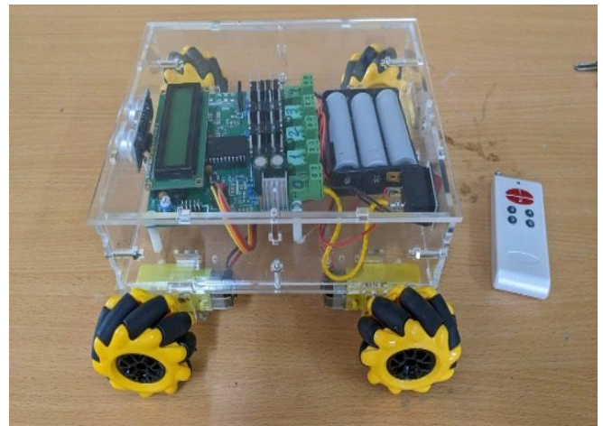
Hình 21. Lắp ráp hoàn thiện bánh xe và mạch
