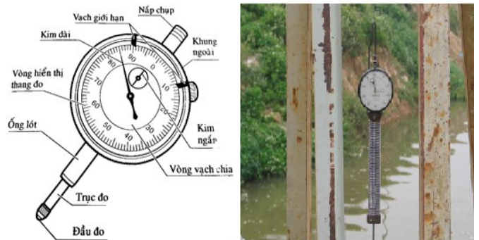
Hình 9. Đồng hồ đo chuyển vị Indicator [6]
