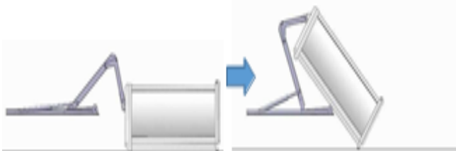
Hình 7. Hành trình nâng thùng có tải giai đoạn 1
