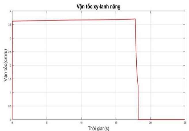
Hình 19. Đồ thị vận tốc xylanh nâng giai đoạn 2 – nâng thùng đầy tải
