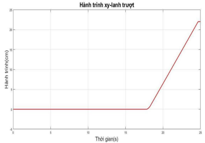
Hình 18. Đồ thị hành trình xylanh trượt giai đoạn 2 – nâng thùng đầy tải
