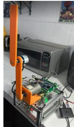
Hình 4. Hệ Pendubot cân bằng ổn định tại vị trí TOP khi ứng dụng BDK backstepping
