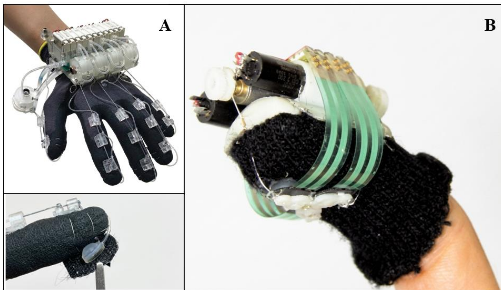
Hình 4. Các thiết bị sử dụng cơ chế kích thích pháp tuyến. A: Thiết bị găng tay HaptGlove (Phòng theo [37]). B: Thiết bị tái tạo xúc giác 3 bậc tự do (Phòng theo [35])
