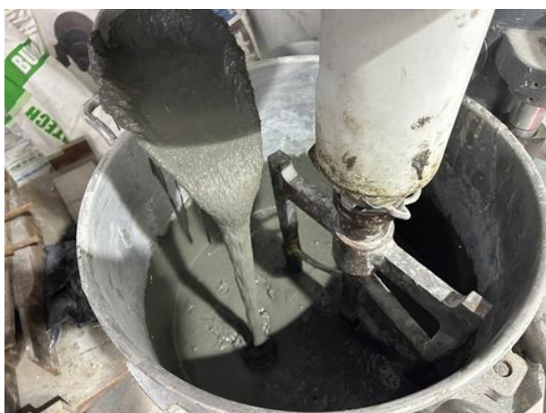
Hình 3. Máy trộn cường bức bốn cấp độ
