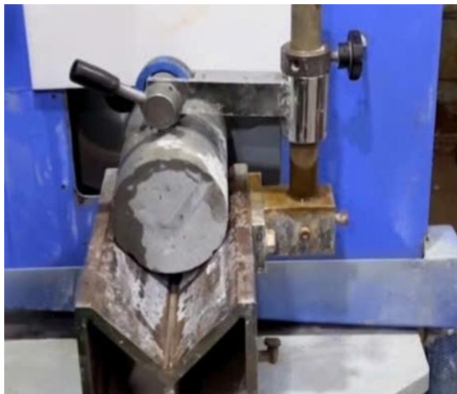
Hình 5. Mài phẳng mẫu trụ UHPC
