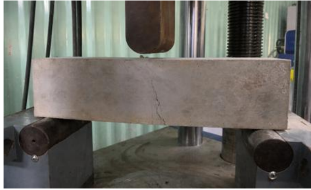
Hình 10. Thử nghiệm uốn ba điểm dầm UHPC
