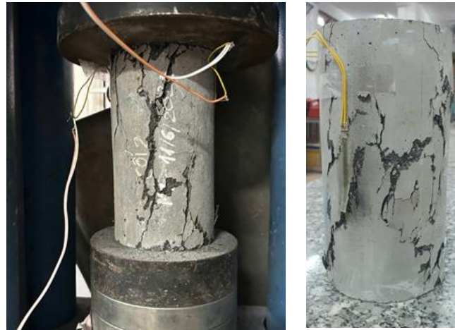
Hình 7. Thí nghiệm nén mẫu UHPC
