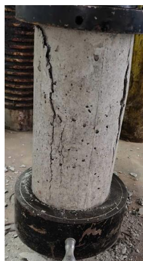
Hình 1. Hình ảnh mẫu bê tông geopolimer sau khi đúc và thí nghiệm nén mẫu
