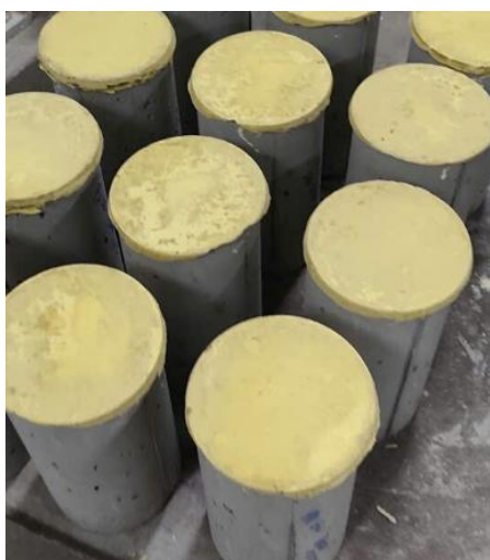
Hình 1. Hình ảnh mẫu bê tông geopolimer sau khi đúc và thí nghiệm nén mẫu
