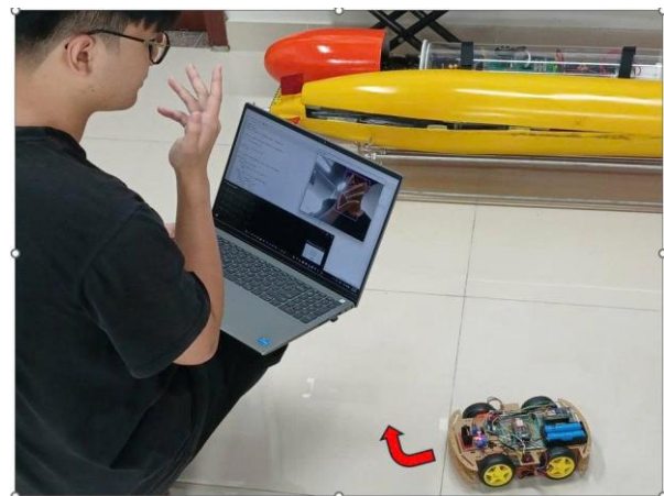
Hình 23. Thực nghiệm mô hình xe điều khiển từ xa sử dụng công nghệ hand-tracking.
