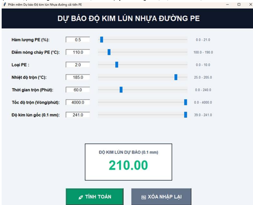
Hình 8. Giao diện người dùng dự báo độ kim lún nhựa đường PE
